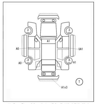
凹•曲 腐食 修理跡 交換跡 割•穴 変色 さび O S •
