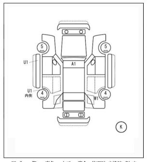
凹•曲 腐食 修理跡 交換跡 割•穴 変色 さび S A
